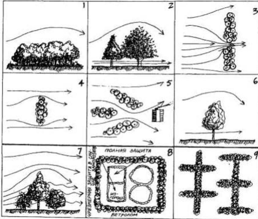
**Рисунок 2.16 НЕЭФФЕКТИВНЫЕ ТИПЫ ВЕТРОЛОМОВ:** 1)чрезмерная ширина; 2)нижние ветви засохли, срезаны или обгладываются животными — ветер проникает снизу; 3) скорость ветра увеличивается при прохождении через брешь (эффект Вентури); 4)недостаточная протяженность; 5) ветролом не расположен перпендикулярно к направлению ветра; 6)имеется всего один ряд деревьев
